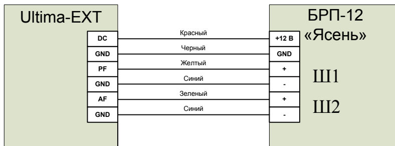
Рис. 4а. Схема подключения контроллера к источнику питания
